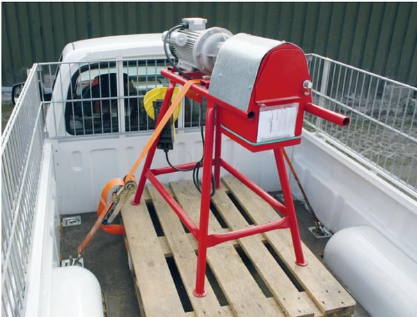
Für den Transport gesicherte Wacker Putz- und Fräsmaschine
