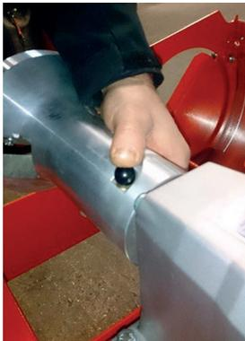
Abb. 4 Abziehen mit gedrücktem Kugelkopf.
